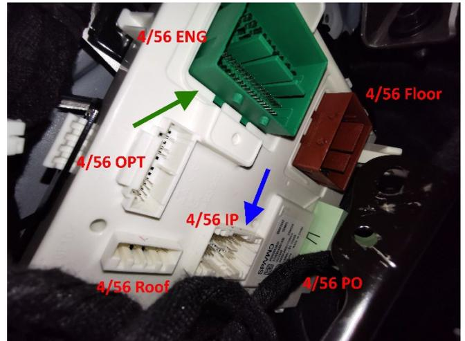
Benötigt werden der Stecker „4/56 ENG“ (CAN-Bus) und der Stecker „4/56 IP“ (Hupe und Warnblinker), am Bordnetzsteuergerät.
