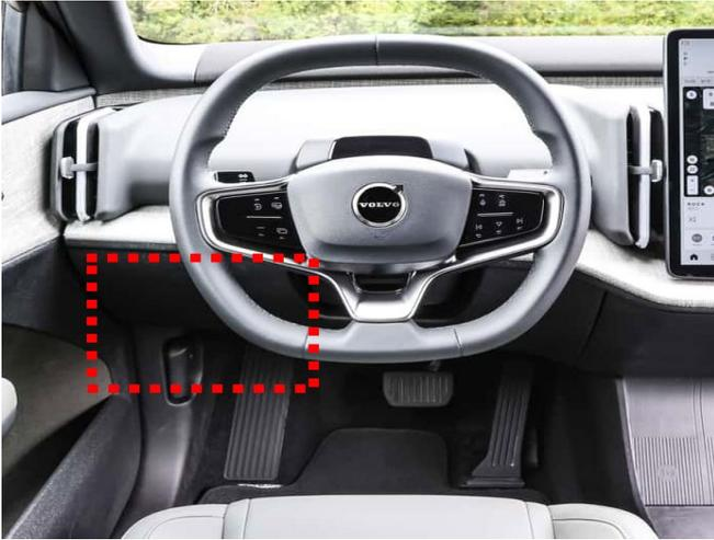
Die Abgriffspunkte für CAN-Bus, Hupe und Warnblinker befinden sich alle am Bordnetzsteuergerät, oberhalb des Fahrerfußraumes, links der Lenksäule.
