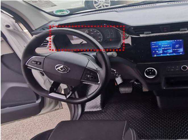
Der Abgriffspunkt für den CAN-Bus befindet sich am Stecker für das Kombiinstrument. Zum Erreichen muss das Kombiinstrument ausgebaut werden.
