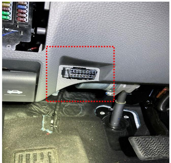
Der benötigte CAN-Bus befindet am OBD Stecker.
