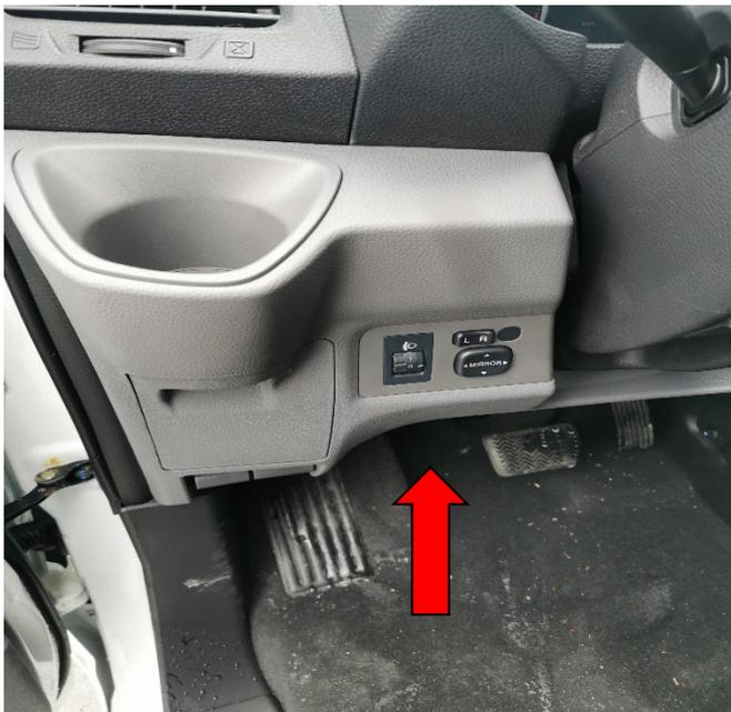
Der OBD-Anschluss befindet sich im Fahrerfußraum.
