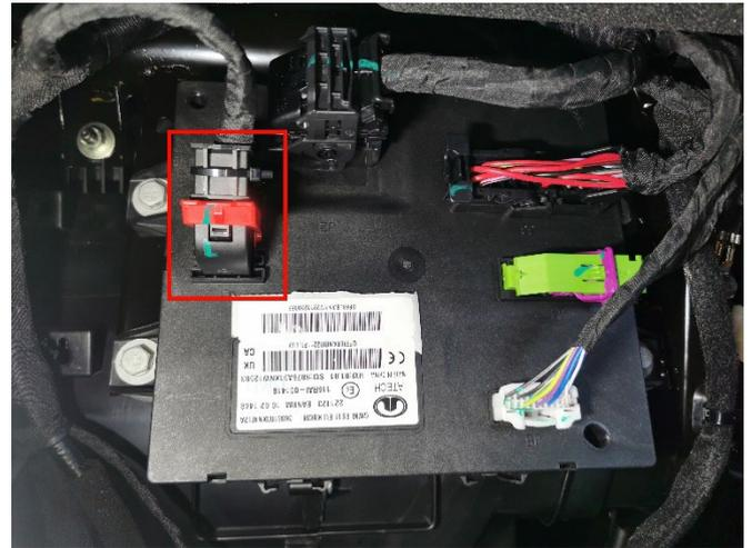
Stecker J1 vom BCM abstecken und durch die Öffnung des Klimabedienteiles ziehen. Kabelbinder abzwicken und Steckergehäuse abziehen.
