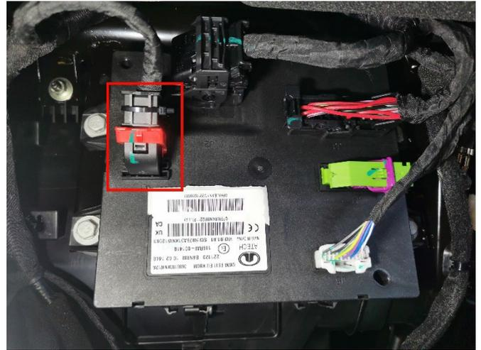
Stecker J1 vom BCM abstecken und durch die Öffnung des Klimabedienteiles ziehen. Kabelbinder abwickeln und Steckergehäuse abziehen.
