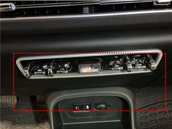
Der Angriffspunkt befindet sich am Body Control Modul hinter dem Klimabedienteil. Klimabedienteil herausziehen.
