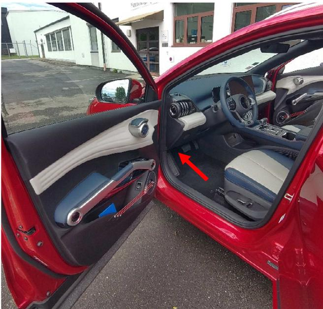
Der OBD-Anschluss befindet sich im Fahrerfußraum.
