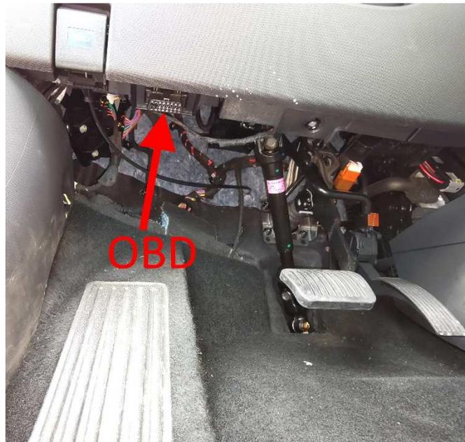
Der benötigte CAN-Bus befindet am OBD Stecker.
