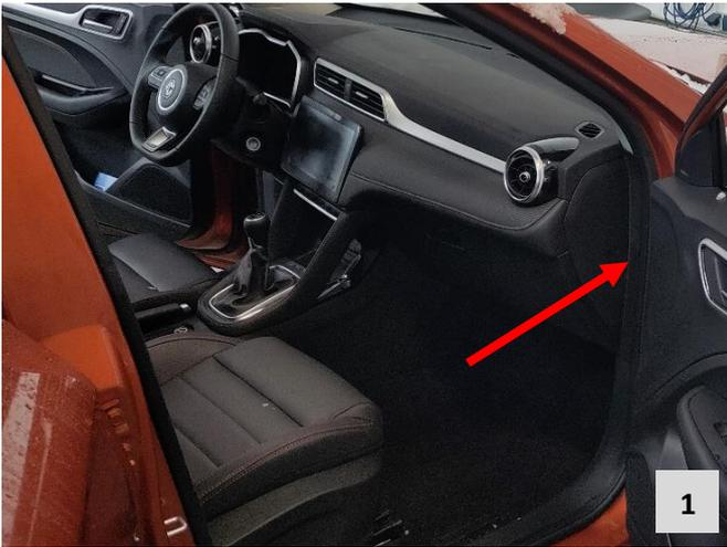
Der benötigte CAN-Bus befindet sich rechts oben im Beifahrerfußraum hinter dem Handschuhfach an der BCM.
