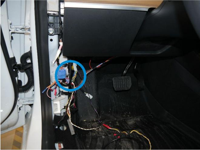
Einstiegsleiste und innenliegende Abdeckung im Fahrerfußraum entfernen. Der benötigte Stecker befindet sich links, an der Karosseriewand.
