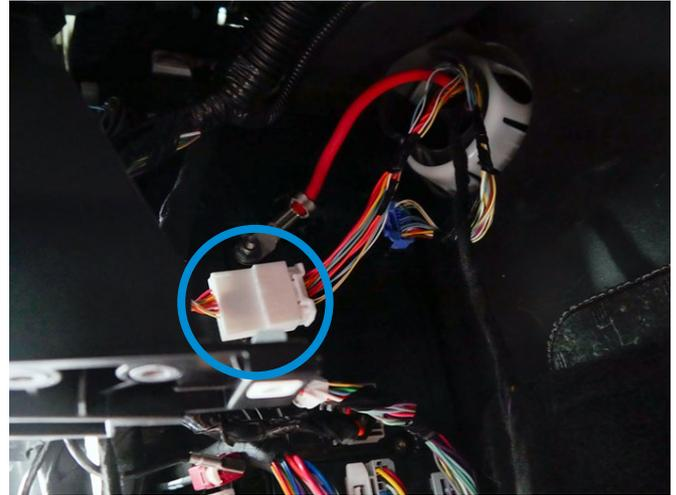
Der Stecker ist durch den Fahrerfußraum erreichbar und befindet sich innenliegend an der A-Säule.
