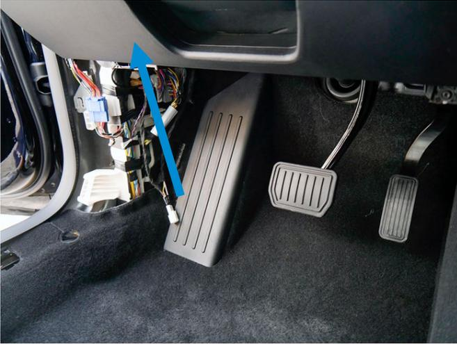
Einstiegsleiste und innenliegende Abdeckung im Fahrerfußraum entfernen. Der benötigte Stecker befindet sich ca. 30cm oberhalb der Fußablage.
