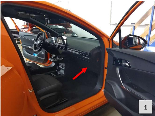
Der benötigte CAN-Bus befindet sich rechts oben im Beifahrerfußraum hinter dem Handschuhfach am Gateway
