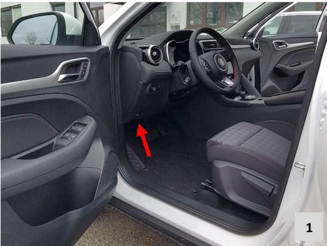
Der benötigte CAN-Bus befindet sich links oben im Fahrerfußraum am Gateway.
