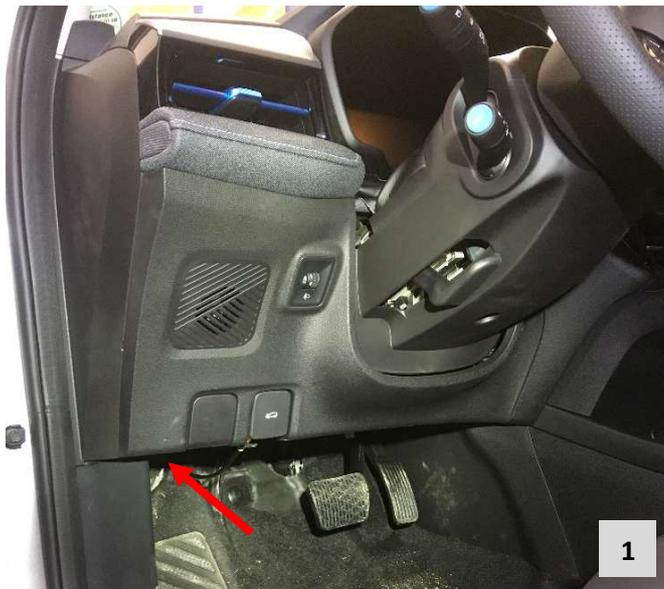
Der benötigte CAN-Bus befindet sich links oben im Fahrerfußraum am BCM.
