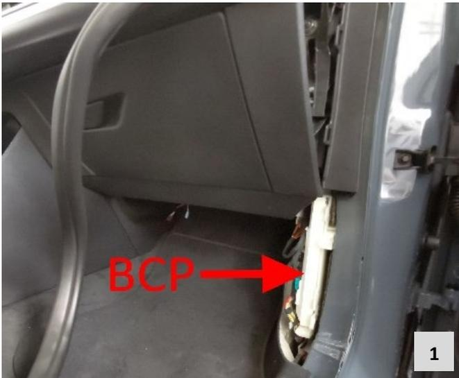
Der Abgriff befindet sich am BCP im Beifahrerfußraum.
