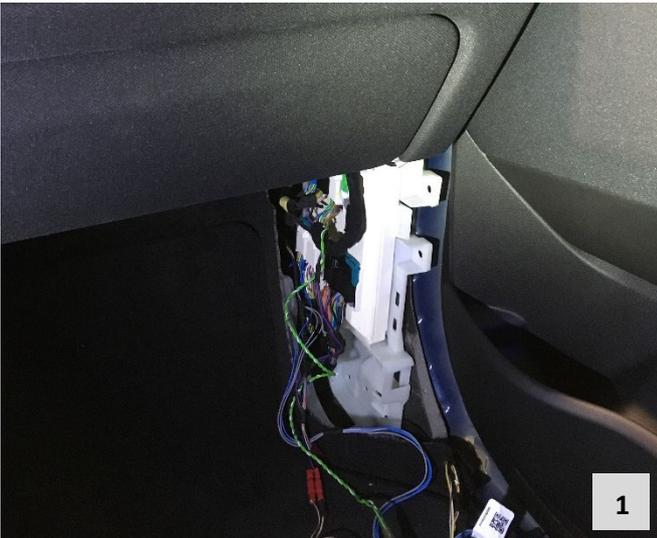
Der benötigte CAN-Bus befindet sich am BCP im Beifahrerfußraum. Dieser ist am schwarzen Stecker CON7 und CON8 zu finden.
