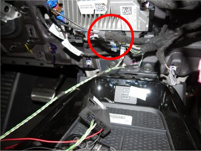
Abgegriffen wird am markierten Stecker oberhalb der Mittelkonsole.
