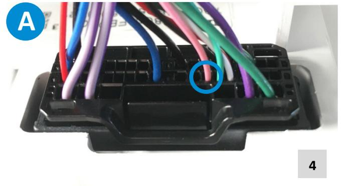
Ansteuerung Warnblinker: Hinter Kombiinstrument.
