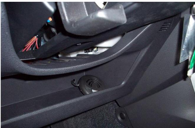
Der benötigte CAN-Bus befindet an der OBD Buchse, unterhalb des Lenkstocks.
