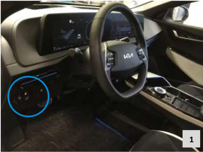
Der benötigte CAN-Bus-Abgriff befindet sich hinter dem beige IGPM-Steuergerät.
