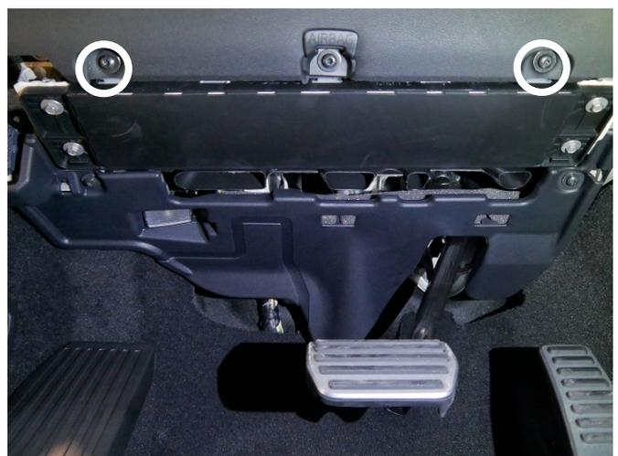
Markierte Schrauben mit einem Torx Schrauben- zieher in Größe 25 lösen und Abdeckung entfernen. Loosen marked screws with a size 25 Torx screw-driver and remove cover.
