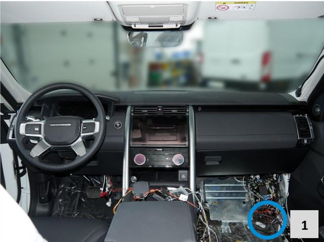
Das BCM befindet sich an markierter Stelle im Beifahrerfußraum hinter dem Handschuhfach.
