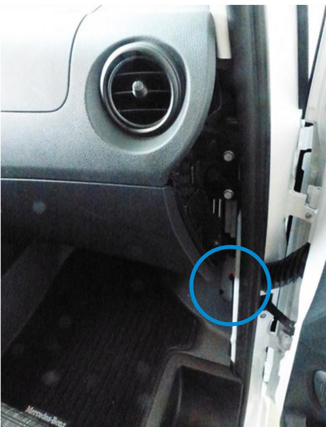
Der benötigte CAN-Bus befindet sich am CAN-Verteiler im Beifahrerfußraum rechts, hinter der Plastikabdeckung.
