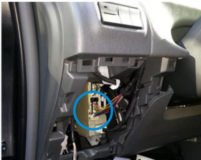
Am weißen Stecker links unter dem Lenkrad befindet sich der Abgriff für Fernlicht und Hupe.
