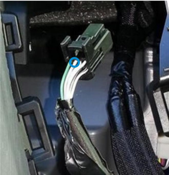
Das Warnblinkersignal wird am schwarzen Stecker hinter dem Warnblinkerschalter abgegriffen: graue Leitung
