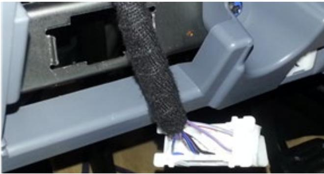
Der CAN-Abgriff wird am OBD-Stecker links, unterhalb der Lenksäule vorgenommen. Der Motor-CAN wird benötigt.
