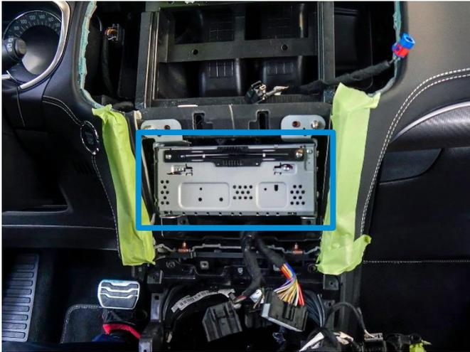
Der benötigte CAN-Bus befindet sich hinter dem Radio bzw. dem Klimabedienteil. Der Abgriff erfolgt am 24-poligen Stecker an der Rückseite des Radios.
