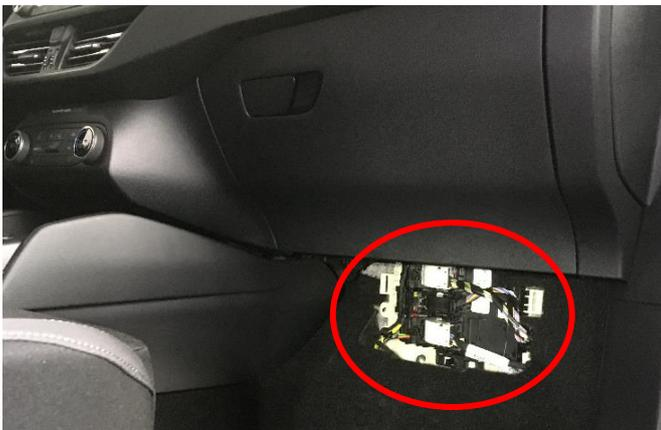
Das Hupensignal muss analog an der BCM abgegriffen werden. Diese befindet sich an markierter Stelle im Beifahrerfußraum.
