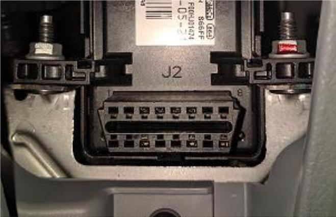
Beim Transit mit OBD-Steuergerät befindet sich der benötigte CAN-Bus am grauen Stecker rechts, neben der OBD-Buchse.
