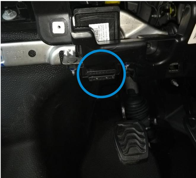
Der CAN-Bus wird am Gateway-Stecker abgegriffen. Dieser befindet sich an markierter Stelle oberhalb der Pedalerie.
