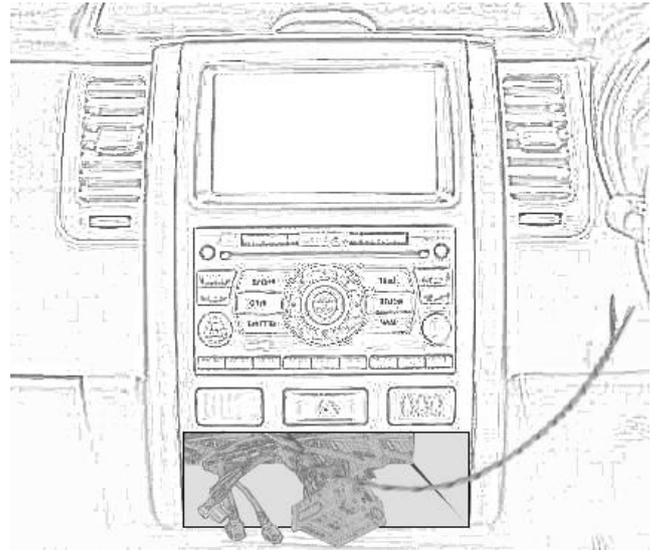
Der CAN-Bus befindet sich hinter der Klimaanlage:
