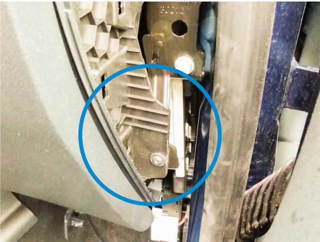
Der benötigte CAN-Bus befindet sich hinter der Abdeckung an der A-Säule im Beifahrerfußraum.
