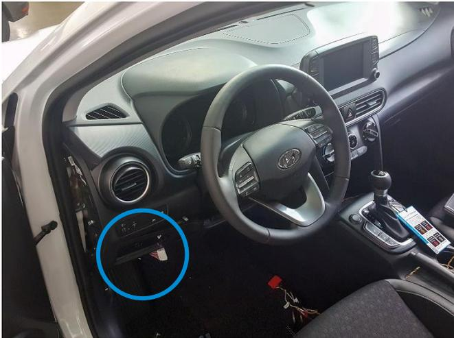
Der benötigte CAN-Bus befindet sich an der Rückseite des BCM. Das BCM befindet sich an markierter Stelle.
