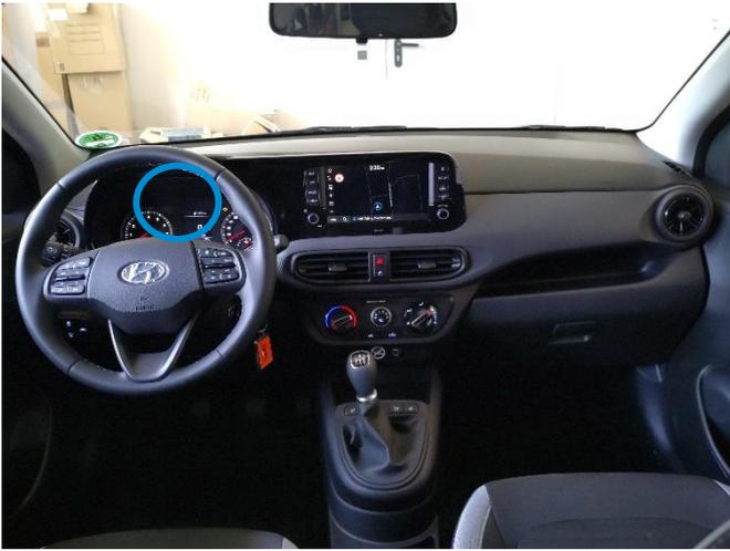
Der benötigte CAN-Bus befindet sich an der Rückseite des Kombi-Instruments. Das Kombi-Instrument befindet sich an markierter Stelle im Fahrzeug.
