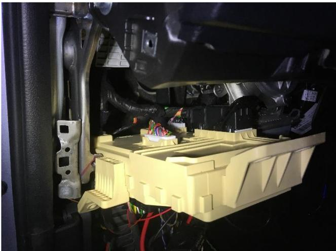
Der benötigte CAN-Bus befindet sich an der Rückseite der ICU. Steuergerät ausbauen und an Stecker G abgreifen.
