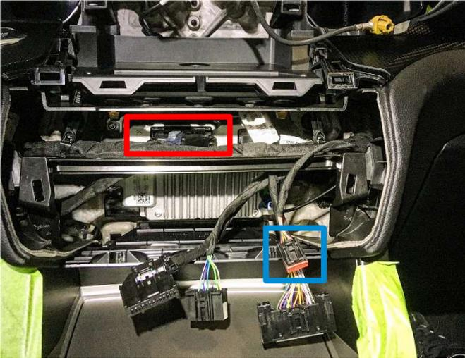
Der benötigte CAN-Bus (HS1) befindet sich am rot markierten, 54-pol. Stecker.
