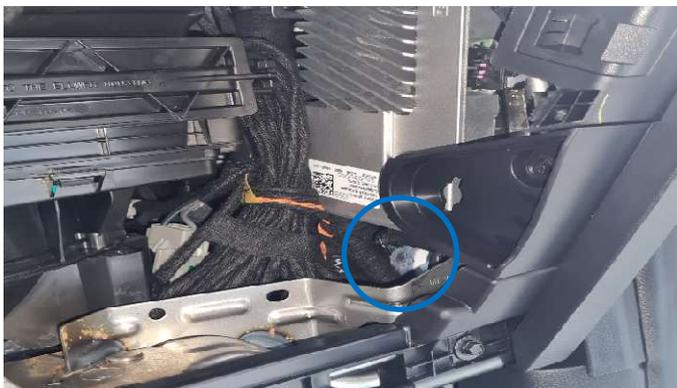
Das CAN-Gateway befindet sich auf der rechten Seite. Trennen Sie die markierte Verbindung
