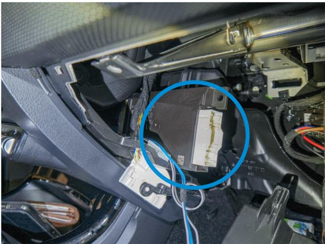
Der benötigte CAN-Bus befindet sich am 40-poligen, blauen Stecker an der ECU (Electronic Control Unit). Diese befindet sich hinter dem Handschuhfachkasten. Um die ECU zu erreichen, muss der Handschuhfachkasten ausgebaut werden.
