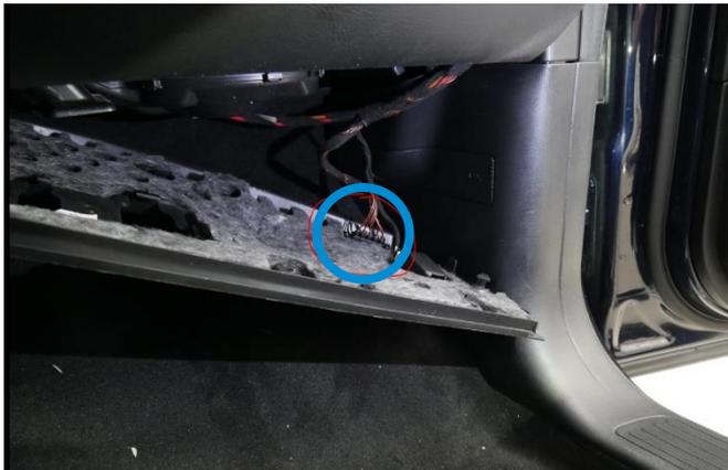
Der benötigte CAN-Bus befindet sich im Beifahrerfußraum hinter der Plastikverkleidung an markierter Stelle.
