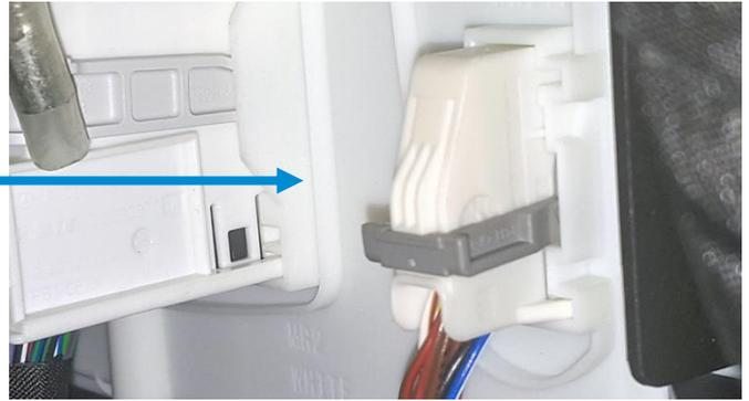
Der benötigte CAN-Bus befindet sich am SAM-Steuergerät im Beifahrerfußraum rechts. Um dieses zu erreichen, müssen die Plastikverkleidungen entfernt werden.
