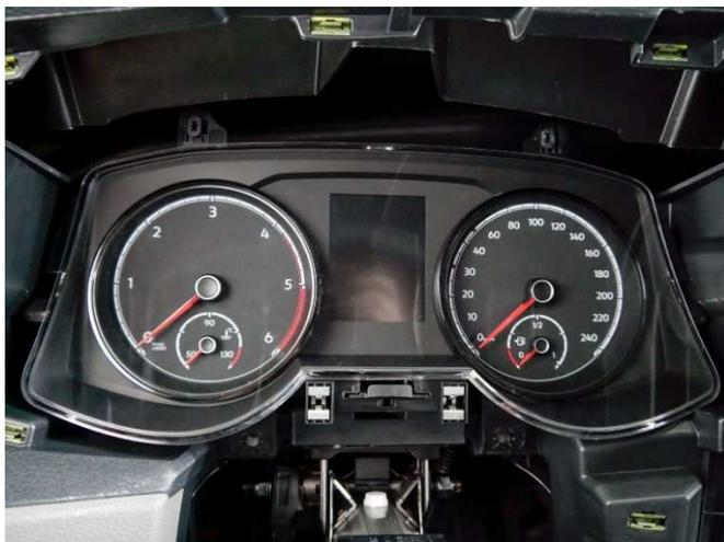
Abdeckung um das Kombiinstrument ausbauen und zwei Schrauben (Torx 20) lösen. Benötigt wird der Stecker direkt am Kombiinstrument mit der pinken Kappe.
