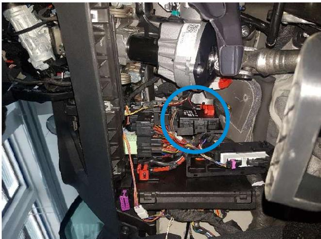
Das Gateway befindet sich an markierter Stelle, oberhalb der Pedalerie. Hier kann sowohl das Plug&Play Kabel, als auch das Kabel mit offenen Kabelenden angeschlossen werden.
