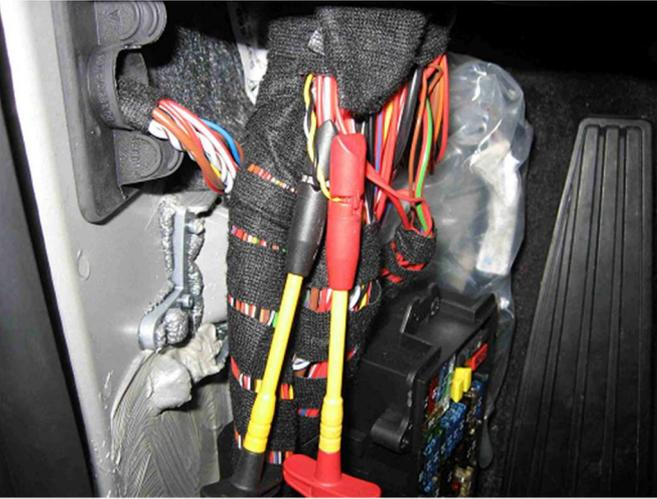
Beim Sicherungskasten im Fahrerfußraum verlaufen mehrere gelb-schwarz verdrehte CAN-Bus-Paare. Auch der Komfort CAN-Bus ist darunter.
