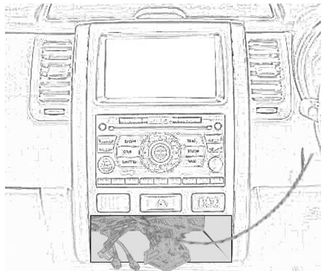
Der CAN-Bus befindet sich hinter der Klimaanlage:
