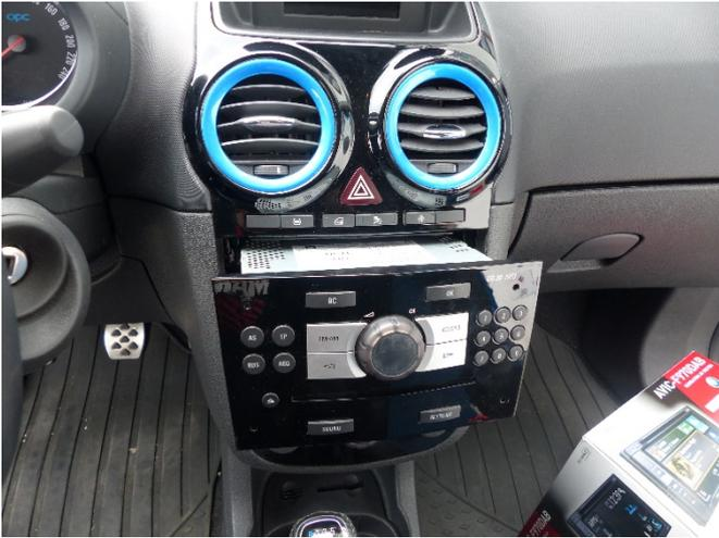
Bauen Sie das originale Radio mit Hilfe des Entriegelungswerkzeugs aus (Entriegelungswerkzeug ist nicht im Lieferumfang enthalten).
