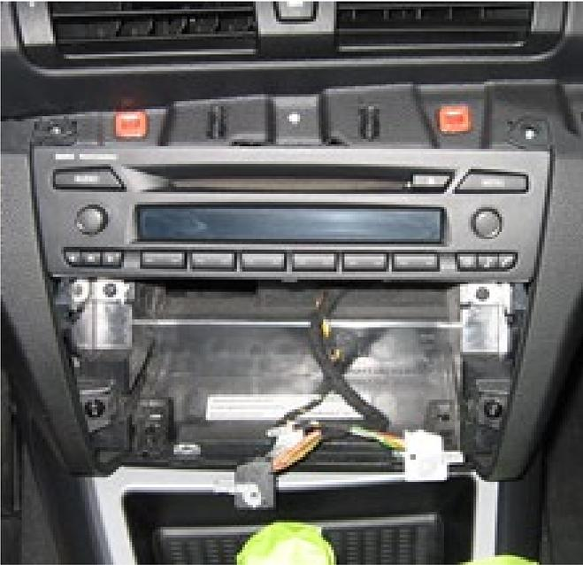
Bauen Sie das originale Radio aus. Hierfür muss das Klimabedienteil mit Blende herausgenommen werden. Zwei Schrauben lösen.
