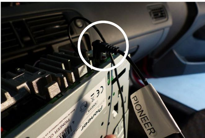
Radiokabel am Eingang SWC anschließen
