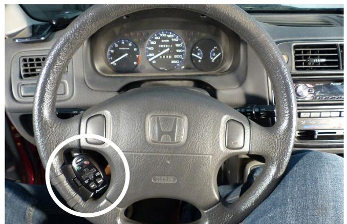
Lenkradfernbedienung am Lenkrad anbringen, in diesem Bsp. die Pioneer CD-SR 110
