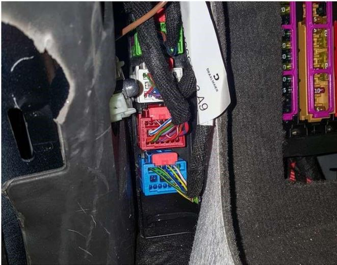
Die benötigten Stecker befinden sich im Fahrerfußraum links an der A-Säule auf Höhe der Einstiegsleiste. Verkleidung an A-Säule entfernen und anschließend den Teppich herausklappen.
