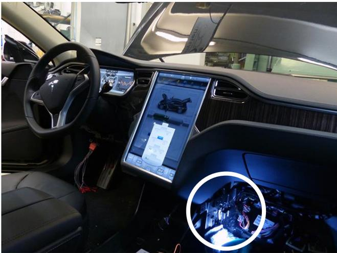
Der benötigte CAN-Bus befindet sich im Beifahrerfußraum an der Mittelkonsole. Benötigt wird der Stecker vom Wechsler unter dem Bildschirm (Wechsler ausgebaut).
