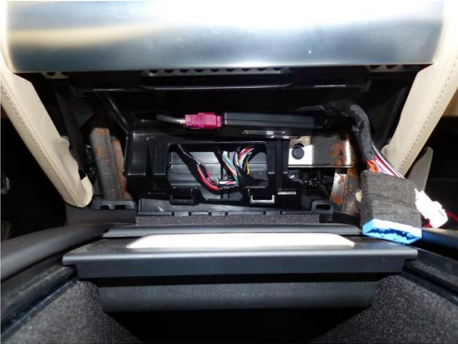
Der benötigte CAN-Bus befindet sich unterhalb des Displays am blauen Stecker.
