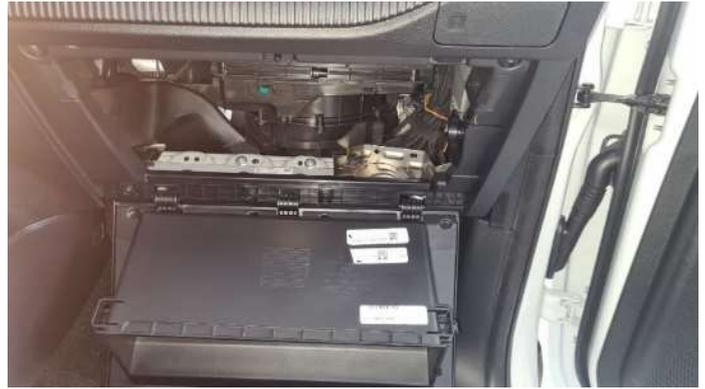
Der CAN-Bus Abgriff befindet sich im Beifahrerfußraum hinter dem Handschuhfach.
