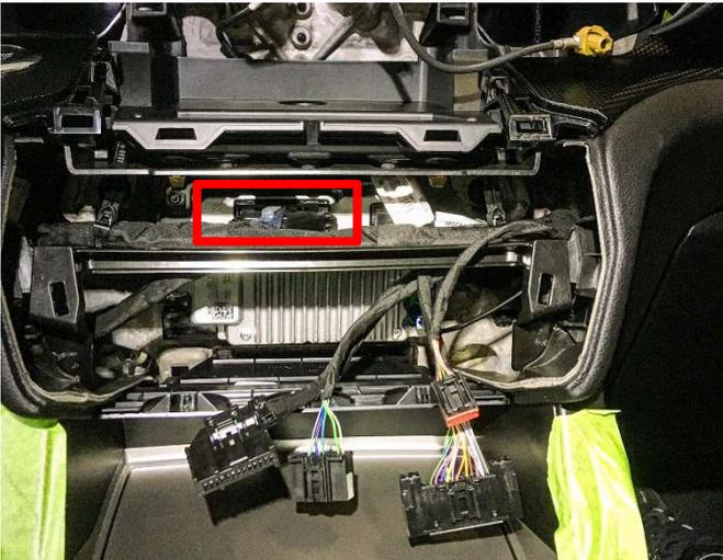
Der benötigte CAN-Bus (HS1) befindet sich am markierten, 54-pol. Stecker.
