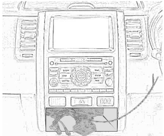
Der CAN-Bus befindet sich hinter der Klimaanlage:
