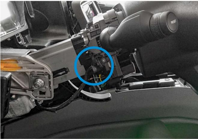
Verkleidung um Lenkstock entfernen. Dafür müssen drei Torx 25 Schrauben gelöst werden. Danach den markierten Stecker abstecken.
