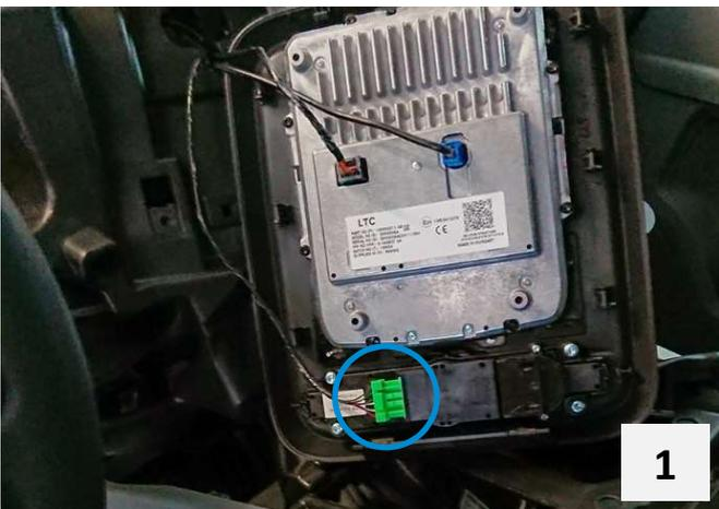
Bedienteil mit Hilfe des Ausbauerwerkzeugs lösen und grünen Stecker abstecken.
