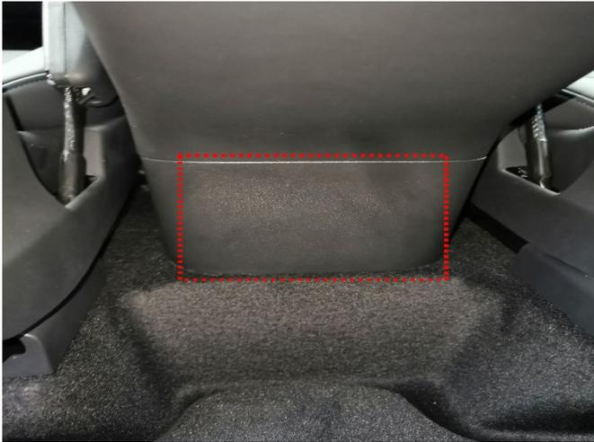
Der Abgriffspunkt für den CAN-Bus befindet sich unter der hinteren Abdeckung der Mittelkonsole, erreichbar über den Fond des Fahrzeugs.
