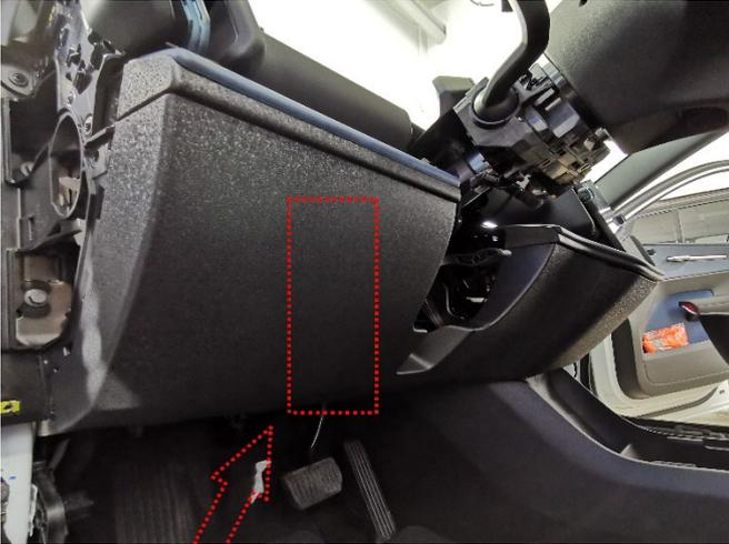
Der Abgriffspunkt befindet sich über dem Fahrerfußraum, links von der Lenksäule, an der Head Unit.
