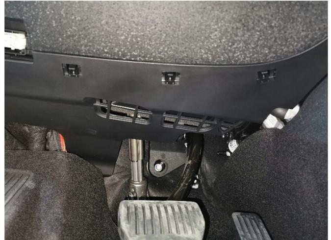
Fahrerfußraumverkleidung ausbauen, dazu links und rechts zwei Spreiznieten herausziehen und die drei Entriegelungsnasen in der Mitte drücken.
