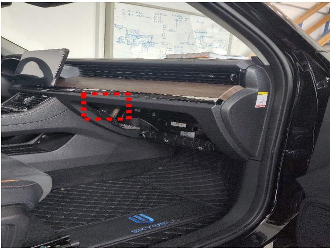
Das Gateway befindet sich auf der Beifahrerseite hinter dem Handschuhfach.
