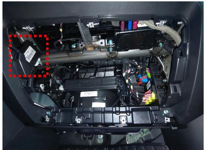
Der benötigte CAN-Bus befindet sich am Gateway.
