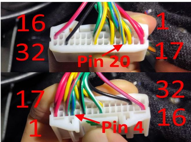
CAN-Bus Abgriffspunkt: Tapping point CAN-bus:
