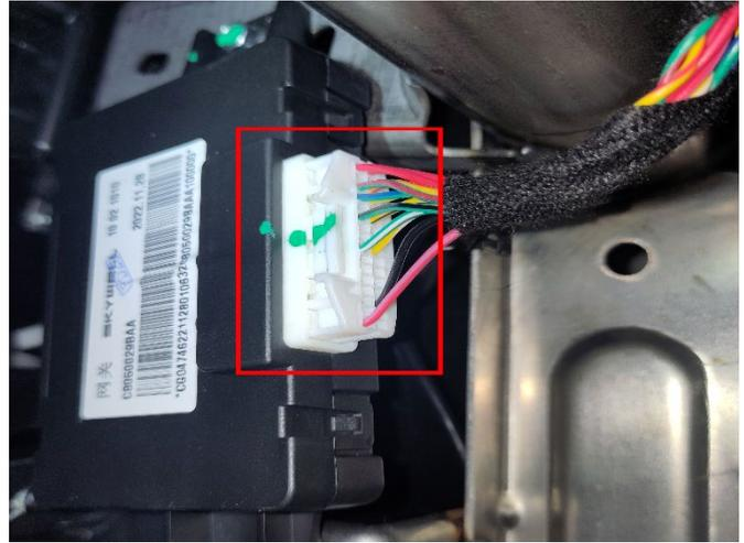
Der Abgriffspunkt für den benötigten CAN-Bus befindet sich am Stecker des Gateways.
