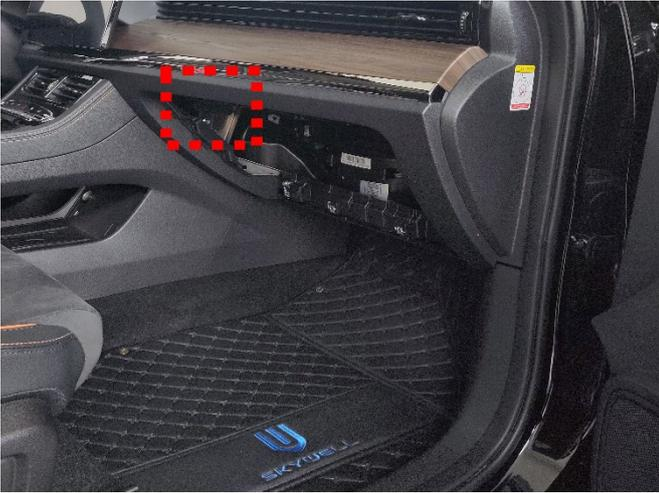
Das Gateway befindet sich auf der Beifahrerseite, links-hinter dem Handschuhfach.
