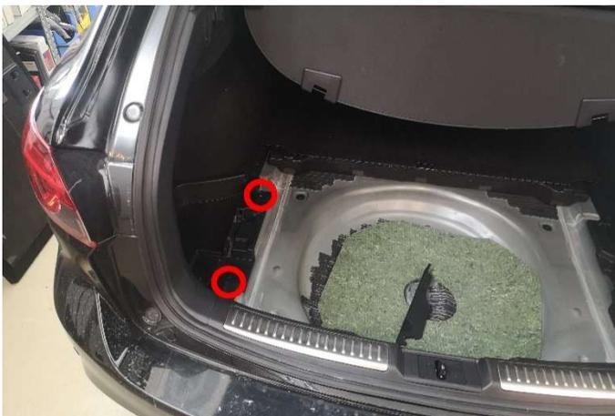
Die Befestigung an den markierten Stellen entfernen und die linke Ablagefläche ausbauen.
