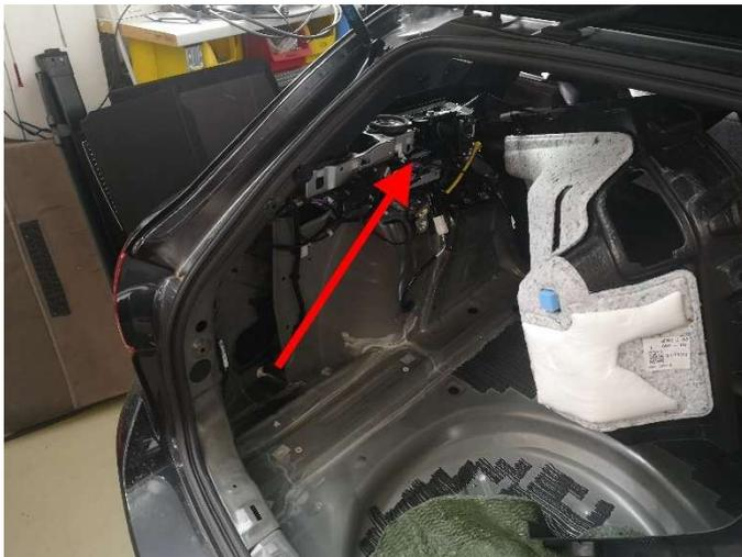
Das RBCM befindet sich an der gezeigten Position im Kofferraum. Um das RBCM zu erreichen, die linke Seitenverkleidung im Kofferraum lösen. Dieser Vorgang wird im Weiteren genauer erklärt.
