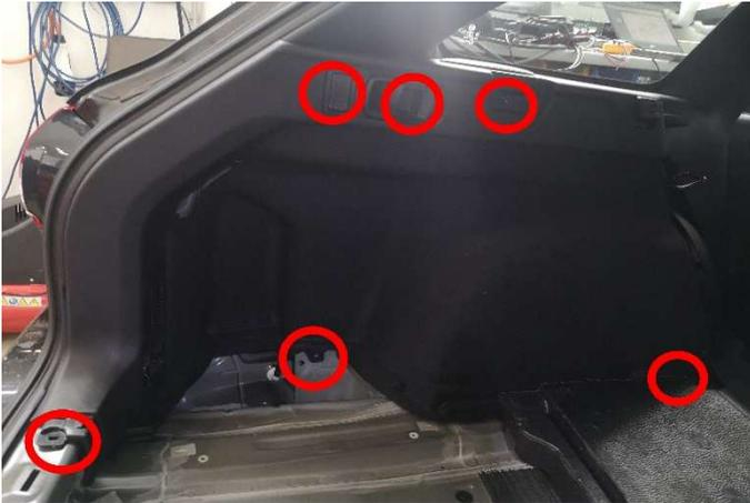
Die Schrauben / Clips an den markierten Positionen entfernen und die seitliche Kofferraumabdeckung lösen.
