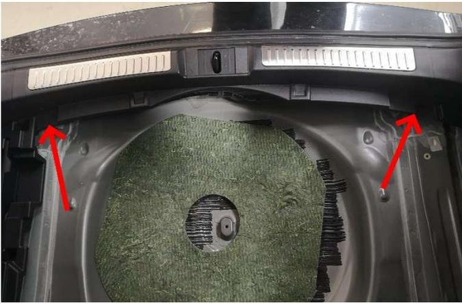
Die Kofferraumbodenabdeckung herausnehmen und die Clips an den markierten Stellen entfernen. Jetzt kann die Abdeckung für den Entladeschutz demontiert werden.
