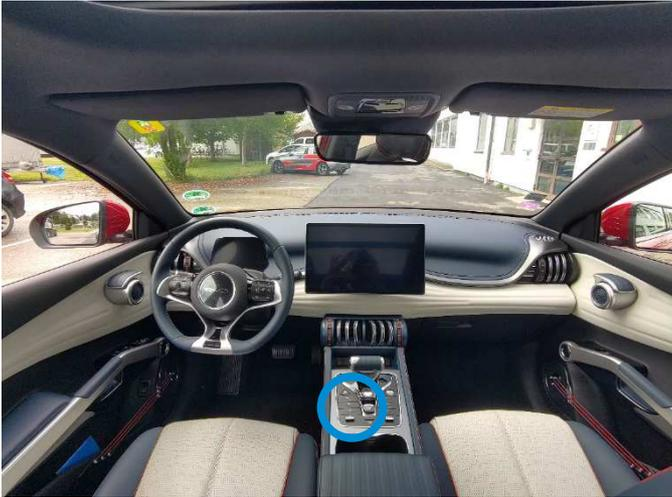
Warnblinkerabgriff befindet sich unter der Mittelkonsole, der Gangwahlhebel kann mit einem kurzen Ruck nach oben gezogen werden.
