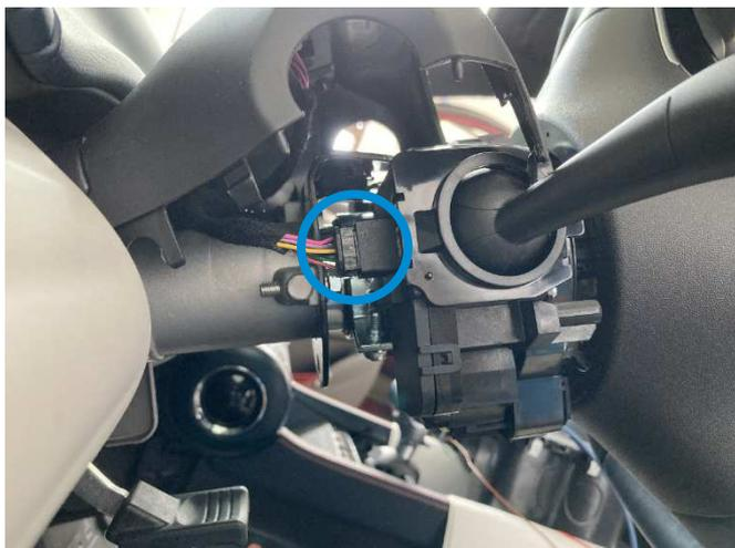
Der benötigte CAN-Bus befindet sich am Lenkstock links am 12-poligen, schwarzen Stecker am Blinkerhebel.
