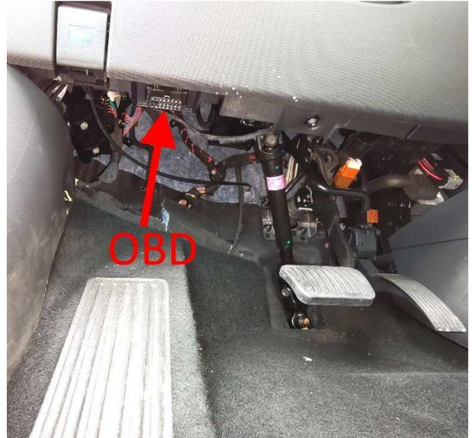
Der benötigte CAN-Bus befindet am OBD Stecker
