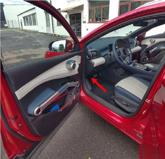
Der OBD-Anschluss befindet sich im Fahrerfußraum.
