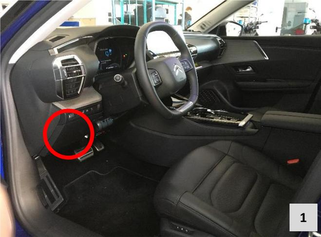
Das Steuergerät VSM 1 befindet sich hinter der Blende im Fahrerfußraum.
