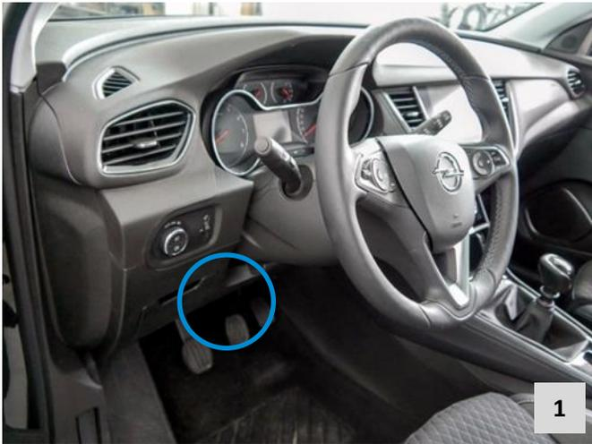
Der benötigte CAN-Bus befindet sich am BSI-Steuergerät. Um diesen zu erreichen muss die Abdeckung im Fahrerfußraum, unterhalb des Lenkrads, entfernt werden.
