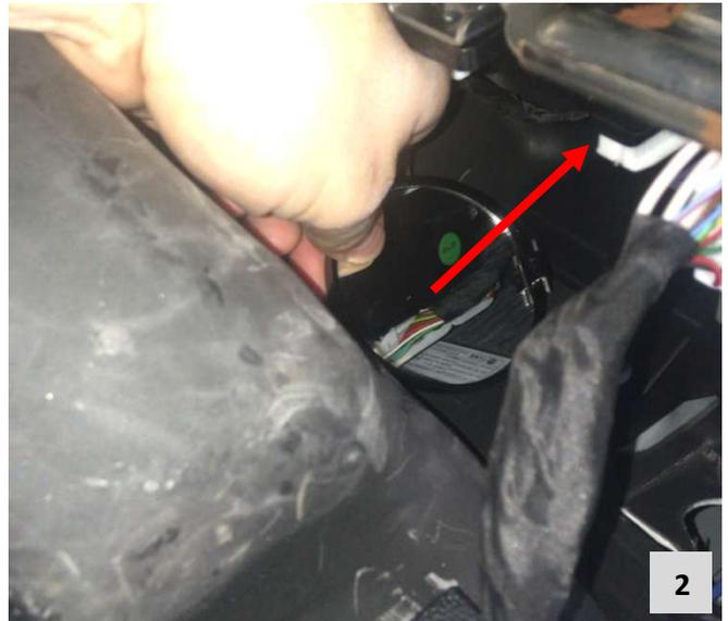
Das Gateway ist mit der Steckerseite zur Fahrzeugaußen-seite verschraubt.
