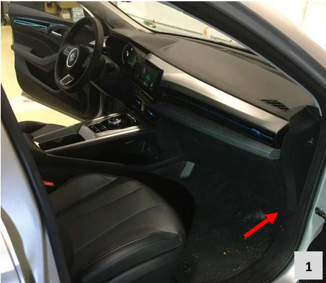
Der benötigte CAN-Bus befindet sich rechts oben im Beifahrerfußraum am Gateway.
