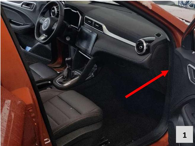
Der benötigte CAN-Bus befindet sich rechts oben im Beifahrerfußraum hinter dem Handschuhfach am BCM.
