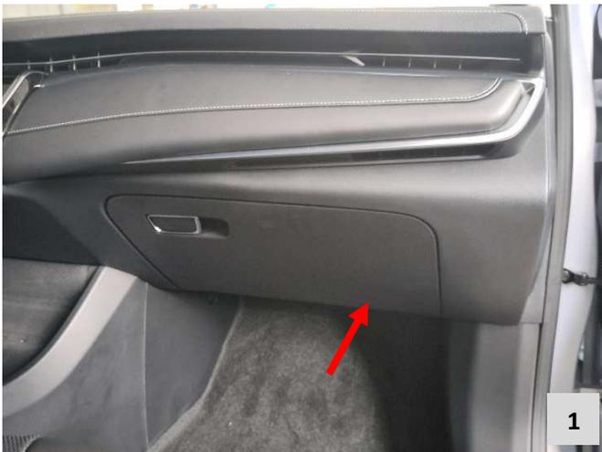
Der benötigte CAN-Bus befindet sich hinter dem Handschuhfach am Gateway.
