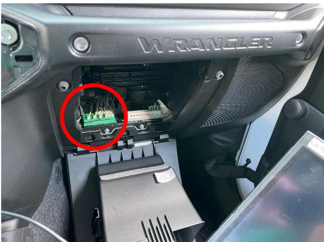
Der benötigte CAN-Bus befindet sich hinter dem Handschuhfach. Benötigt wird der grüne CAN-Verteiler.
