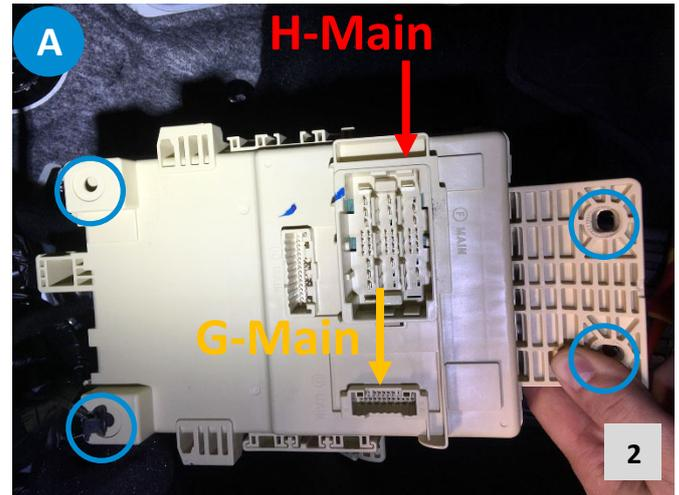
Um an die Rückseite zu kommen, müssen vier Schrauben entfernt werden. Der markierte Stecker wird benötigt.
