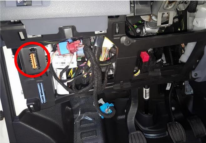
Der benötigte CAN-Bus befindet sich an der OBD II Buchse am orangenen Stecker.
