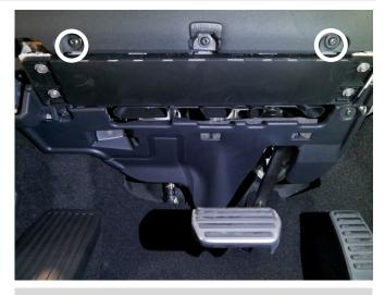
Markierte Schrauben mit einem Torx Schrauben- zieher in Größe 25 lösen und Abdeckung entfernen. Loosen marked screws with a size 25 Torx screw-driver and remove cover.
