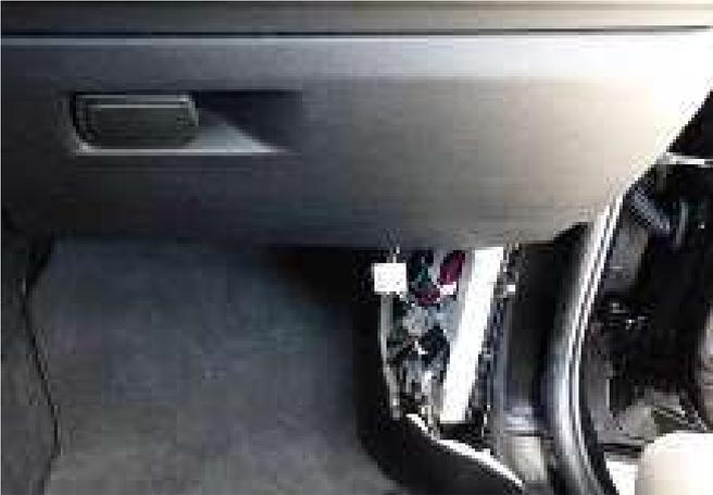
Der benötigte CAN-Bus befindet sich am BDC im Beifahrerfußraum. Dieser ist am weißen, 54-poligen Stecker zu finden.
