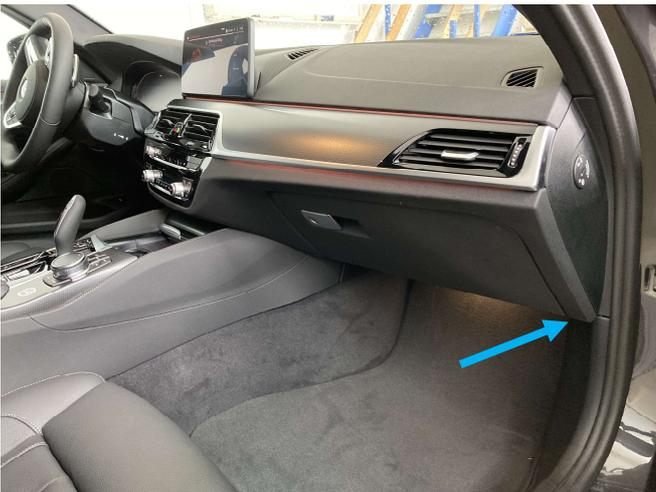
Der benötigte CAN-Bus befindet sich am BCP im Beifahrerfußraum rechts hinter dem Teppich. Dieser ist am schwarzen, 54-poligen Stecker CON8 zu finden.
