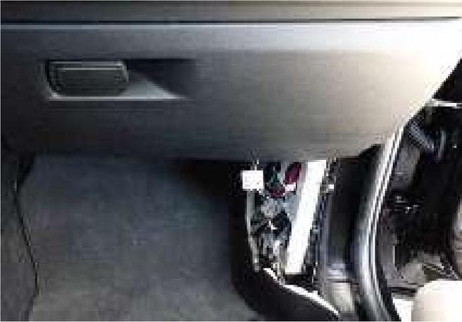
Der benötigte CAN-Bus befindet sich am BDC im Beifahrerfußraum. Dieser ist am schwarzen Stecker zu finden.
