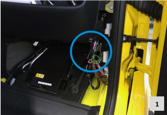
Der benötigte CAN-Bus befindet sich im Beifahrerfußraum am CAN-Verteiler „STERN WHITE“.
