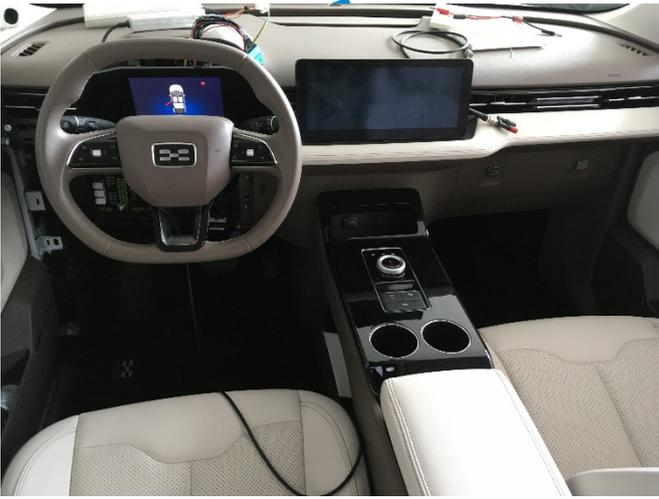
Um den benötigten, blauen Stecker zu erreichen, muss das Kombiinstrument demontiert werden.
