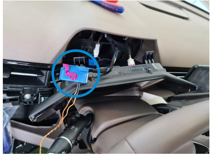
Blauen, 32-poligen Stecker hinterm Kombiinstrument abstecken und Gehäusekappe entfernen.
